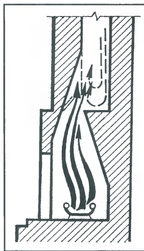
Схема потоков горячих газов и холодного воздуха.
