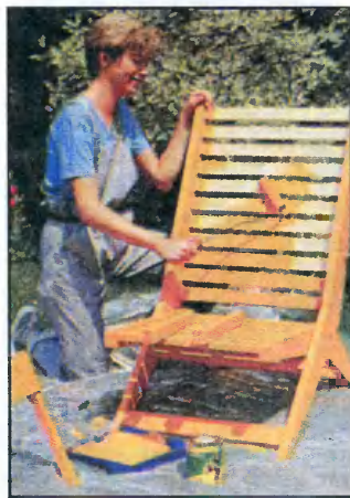
Чтобы обеспечить надежную защиту от атмосферных воздействий, лаком покрывают не только пластину, но и кромки планок.
